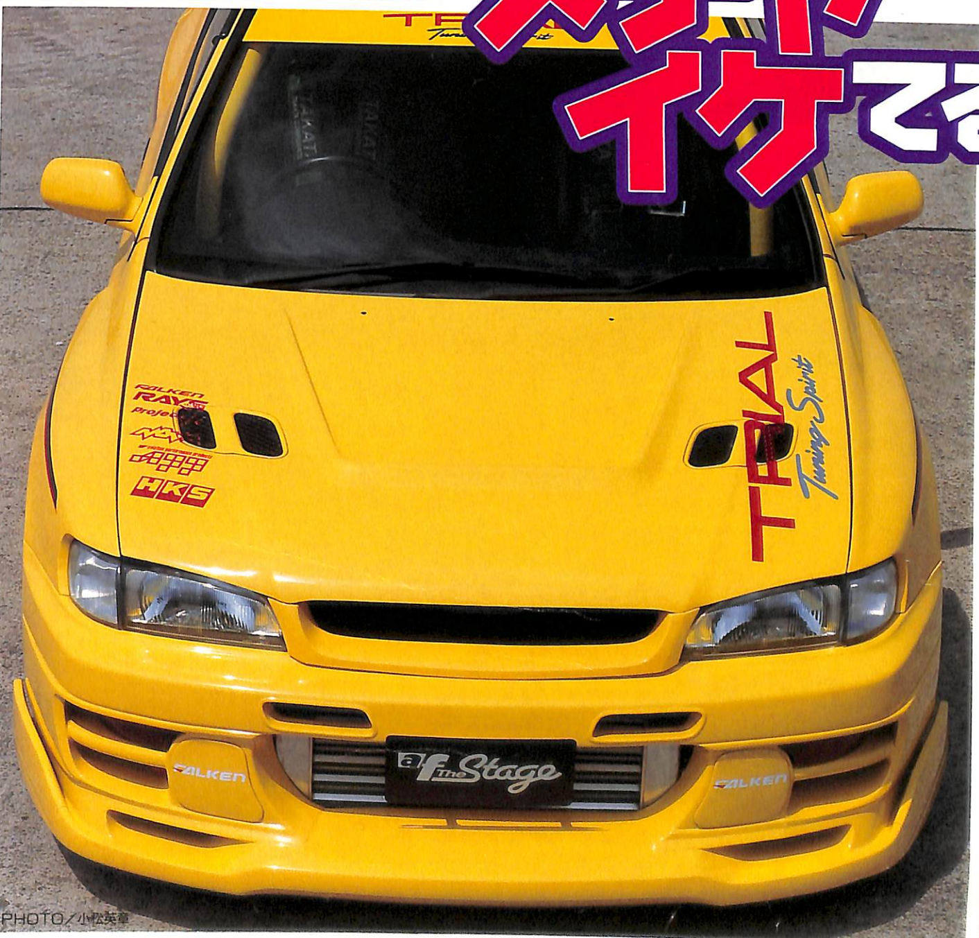
←FRP製のエアロボンネットもインパクト大。大小5箇所もタクトが開けられ、エンジン内にもった熱を逃がす
