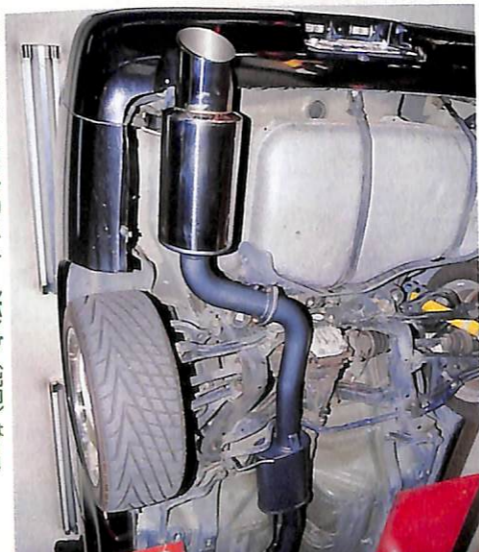
バズーカはメインパイプ80φ、テールパイプ(出口)は140φ。サイレンサーとテールパイプにはステンレスを採用している。価格は8万5000円(工費・税別)だ。
