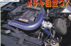
●車のスペシャルインテークカラーやトライアルのCPUなどをセットしたエンジンルーム内の様子
