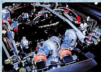
→264度カム、87・5φピストンなどのメカチューンを施し、RX5ツインタービンを回し切る。
