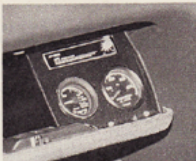
グローブボックスには、アベックスAFC/パワーメーター、トラスト・ブーメーターをセットしているぞ
