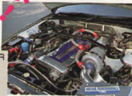
ハイカムにK27タービンで、推定450ps。クラッチはなんとOSのトリプルプレートだというから、ホント、元気なオヤジだ。
