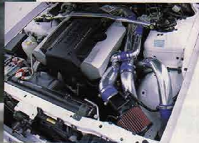
エンジンは、試作のY33ベースの1.8L 4缸DOHCエンジン。ターボチャージャーは、試作のY33ベースの1.8L 4缸DOHCエンジン。ターボチャージャーは、試作のY33ベースの1.8L 4缸DOHCエンジン。
