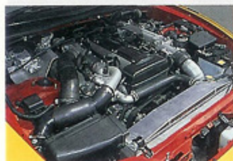
▲2JZ-GTEに、オリジナルのヘッドガスケットやコンピュータを組み込んだグレコスーパー。結果、500ps以上というパワーを絞り出している
