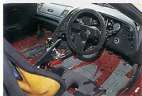
▲バックスキン仕上げのステアリングは36φ。その他バケットシートなど、インテリアはN1仕様らしくレーシーな仕上がりに
