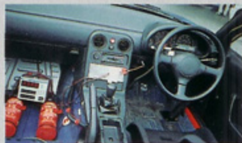
助手席の足元には空燃比計を設置し、データも取った。この結果からコンピューターのセッティングを割り出し、もっともパワーがあり、燃費にもすぐれたセッティングへと詰め直す。結構、本格的でしょう。
