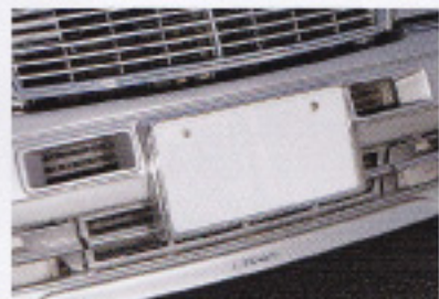
フロントバンパーにインタークーラダクトを追加して、その裏にワンオフインタークーラーをセット。別個でポルトオンターボ仕様であることをアピールする唯一のポイントだ。
