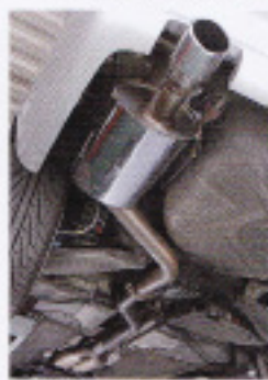
ノーマル仕様後のセンターパイプからつくり直されたワンオフマフラー。テールエンドはノーマルのデュアルスクエアから一時的なシングル出しに変更される。前向きは車種にあわせておくおさえられ、じゅうぶんな使用性能を獲得。美観にスポーティなサウンドで、お乗りで耳ざわりをかんじることはない。
