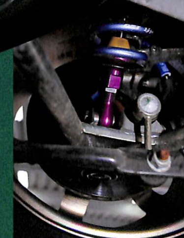
↑藏在車頭裡面的鋁合金加大水箱，是Trial專為這部Exige所訂製的。 ↓避震器為向Quantum訂製的筒身，並搭配Swift製的彈簧，從圖中可以看出為倒叉式設計，而且避震行程相當短。
