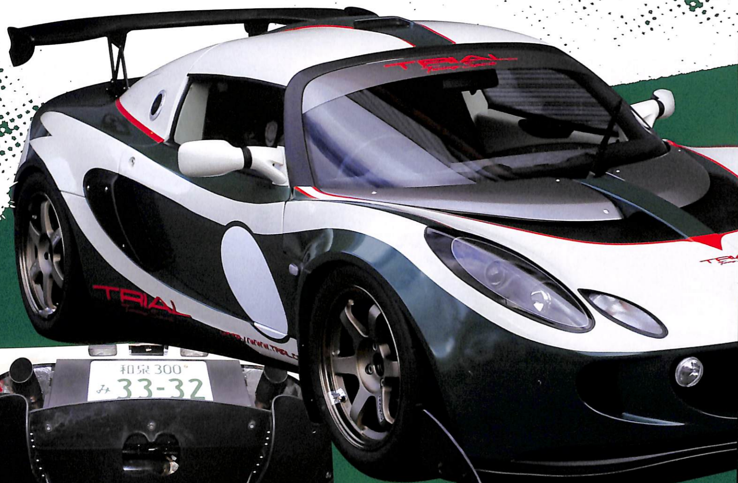
←原廠就配置的後下擾流板，搭配平整的底盤能發揮出絕佳的整流效果；中間的洞為原本排氣管的位置，現在則是改位在左右兩邊的雙出造型。
