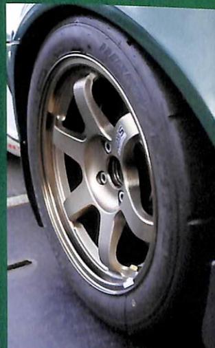
←Exige的底盤由鋁板從頭覆蓋到尾，對於減少車底的亂流，維持行進間的穩定有絕對的幫助。 ↑輪圈為在日本相當有人氣Rays TE37鍛造鋁圈，搭配的輪胎為Dunlop D02G熱溶胎，在抓地性能上可是不輸給人氣胎王A048，也是一條相當不錯的高性能胎。
