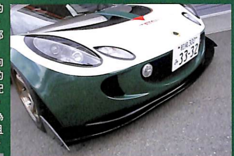
↓車頭下方所加裝的整流板，左右兩邊還有翼端板，整體造型相當類似3D曲面尾翼，只不過窄了點。
