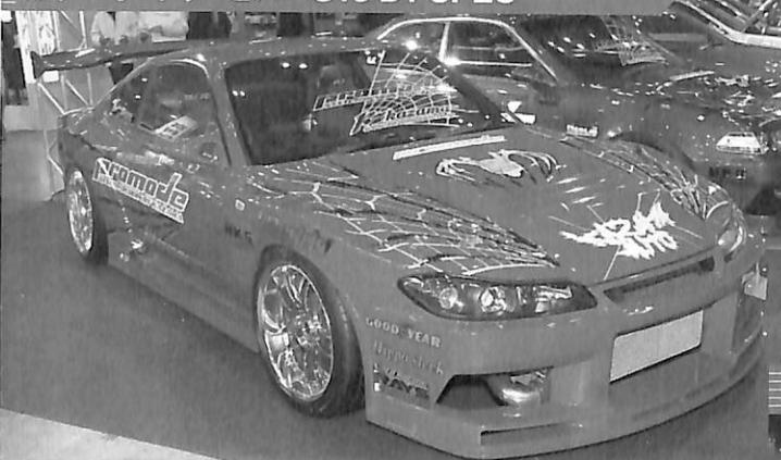
カザマの新作デモカーがこのS15 D1 SPEC。車名のとおりD1グランプリに参戦するマシンだ。筑波サーキットで59秒台を出したS15シリビアをベースに、さらに進化させていく予定だ。エンジンは2.0lのままでラストのT67タービンを装着する。外装はPROMODEブランドのフルキットとなっている。足まわりはHKSのMAX-Dをベースにしたカザマオリジナル
