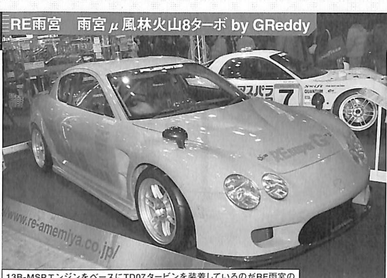
13B-MSPエンジンをベースにTD07タービンを装着しているのがRE雨宮のRX-8だ。ロールバーもシッカリと組み込み、完全にサーキットアタック号としている。パワー的には400psを目指すとか。エアロパーツはもちろんRE雨宮オリジナルのフルキットで、ヨソでは絶対に味わえないスタイルを生み出している
