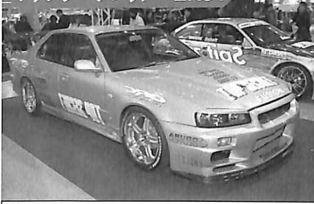
4枚ドアのER34にRB26DETTを載せて650psものパワーを発揮させているのがトップシークレットだ。オリジナルのG-FORCEエアロキット(R34 GT-R用)とR34 GT-Rの前後フェンダーを装着して、見た限りでは完全にGT-R仕様となっている
