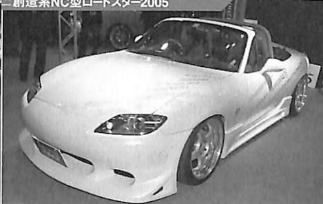
ワンオフで製作したフロントまわりでシャープな印象に生まれ変わったロードスター。ヘッドライトはプロジェクターランプを採用して、ボディ自体もワイド化されているのが特徴的だ。スーパーオートバックスらしくオーディオもシッカリとインストールされていた
