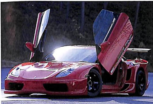
ミッドシップなのでタイヤハウスからドアヒンジまでの空間が短い。そこにキットを詰め込んだのはさすが。
