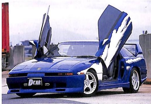
付け根部分をなだらかなS字ヒンジにすることで省スペース化を実現。これにより取り付ける車種を選ばないのだ。
