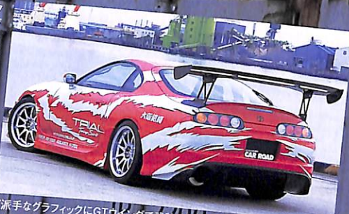
フロントバンパーはカナードとダクトが特徴。3つのダクトが設けられたエアロポネネットと相まって、クーリング性能の高さも見逃せない。ボディラインに見事にマッチしたサイドステップにもダクトを装備。リアバンパーはデューザー風にデザインされ、さらにブラックにペイントすることでレーシングマシンを彷彿とさせる演出がニクイ。カーボン製の大型リアウイングのインパクトも抜群だ。室内のNOSはこれから装着の予定とか
