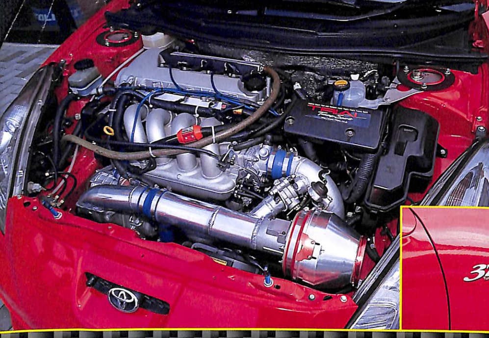
←巨大なブリッツ製エアロインテークだけでタダモノではない雰囲気を漂わせる。エキマニもオリジナルオリジナルだ。→ホテリサイドにはストロークアップキット“3ZZ”のロゴが。
