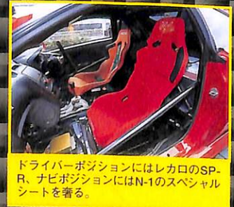
剛性アップを図るため、オリジナルのロールゲージをインテリアにセッティング。大パワーを受け止めるには必須のアイテムだ。
