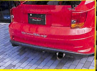
ノーマルセリカのノッペリしたリヤにアクセントを加えるリヤバンパー。マフラーはサーキット用にワンオフで製作したものだ。
