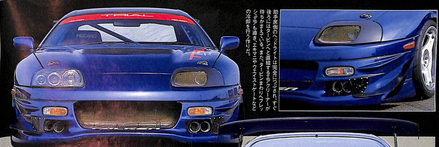
トライアルエアロをベースに、カナードやブレーキダクトの増設など、空力と冷却を考えたエクステリア作り。リヤアンダーのディフューザーも非常にきれいな作りだ。フロントはフェンダーを外にズラす加工、リヤはフェンダーのたたき出し加工がほどこされている。ボディの重量バランスは50:50に限りなく近い数値に収められているそうだ。
