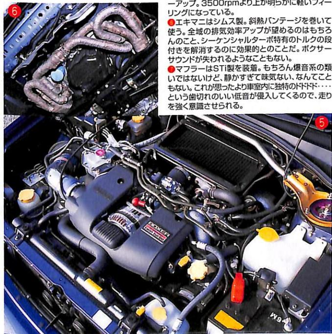
●吸排気系の見直し、Vプロによるロジェトロ制御によって、ブーストはそのまま(1.0kg/cm<sup>2</sup>)で約250ps(ノーマル時実測)から287psまでパワーアップ。3500rpmより上が明らかに軽いフィーリングになっている。
