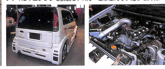
DTMマシンを彷彿させるマッチョなフォルムはC-CUPIによるモノ。1.3ℓエンジンを換装し、Kカーとは思えない走りを実現。
