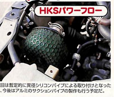
今回は暫定的に異径シリコンパイプによる取り付けとなったが、今後はアルミのサクションパイプの製作も行う予定だ。
