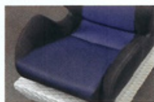
座面はSR-11の基本設計を受け継ぎ、体圧分布の計測と熟練のパネラーによる開発がなされている
