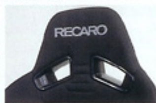
ベルトホールは現在主流の3.5インチ幅ベルトに対応したサイズ。ホール間には伝統の3ストライプ
