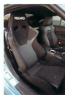
Z34に装着したところ。座面が低い形状なので、アイポイントは純正よりわずかに下がる
