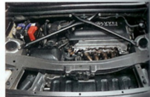
MR-Sには、排気量1794cc、ボア×ストロークはφ79×91.5mmというロングストローク型で、最高出力140ps/6400rpm、最大トルク17.4kgm/4400rpmの1ZZ-FEのみが搭載された。このデモカーはあえてノーマルエンジンのまま、吸排気チューンのみでパワーアップを敢行している。
