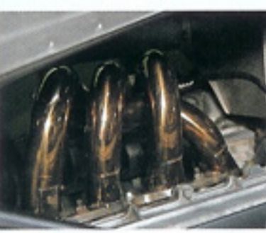
MR-Sには、排気量1794cc、ボア×ストロークはφ79×91.5mmというロングストローク型で、最高出力140ps/6400rpm、最大トルク17.4kgm/4400rpmの1ZZ-FEのみが搭載された。このデモカーはあえてノーマルエンジンのまま、吸排気チューンのみでパワーアップを敢行している。
