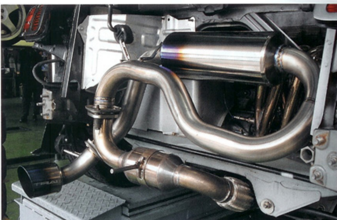
レイアウトはパワーに定評のあるトライフォースのステンレス製マフラーを踏襲。メイン径60φ、テールエンドは100φの泡弾デザインとなる新作のチタンマフラー(13万2000円)。また、触媒にメタルを採用したスポーツキャタライザー(12万7500円)は、セリカ(ZZT231)につづく2車種の設定。まず後期6MT仕様からラインアップされ、つづいて前期5MTが追加される予定だ。
