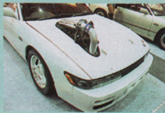
ドンとサージタンクが突き出し運転席から前が見えない。(J7) ガレージ・フィッツのS13。エンジンは2.2&でRX5を組む。
