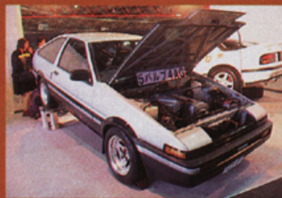
片野商会はAE101の5バルブ4A-GをスワップしたAE86を展示。公認車なのだ。
