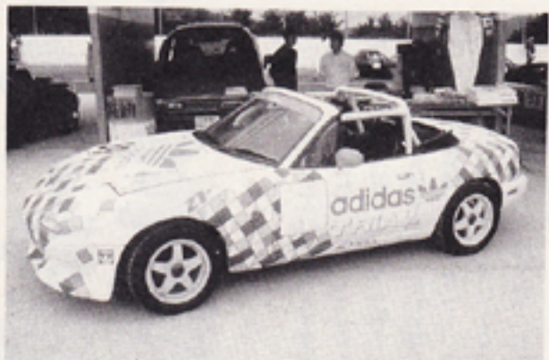
1600NAチューンで最速に挑むトライアル。81番ピストンで1722ccにアップ。4連スロットルでトルクとパワーを絞り出す。今回はヘッドにスペシャル加工を施しており、未知数のポテンシャルを秘めている。
