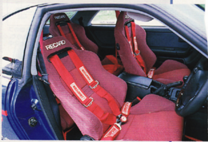
真っ赤なシートベルトがインテリアにマッチしてるでしょ？ フロントシートは3インチの幅広ショルダー、リヤシートは2インチのショルダーベルトタイプを装着している。シンプソン4点式カムロックシートベルトの価格は3インチが4万7000円で、2インチが4万5000円となっている。
