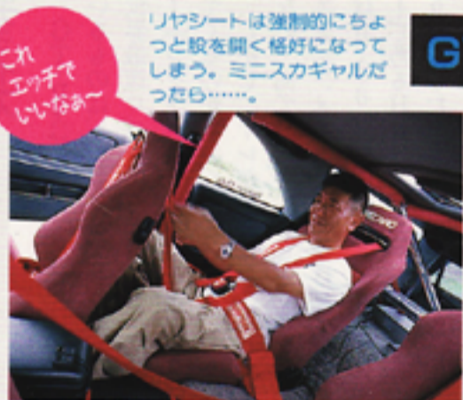
リヤのショルダーベルトはロールケージにマウントされているのだ。もちろん、強度はバッチリだぜ！
