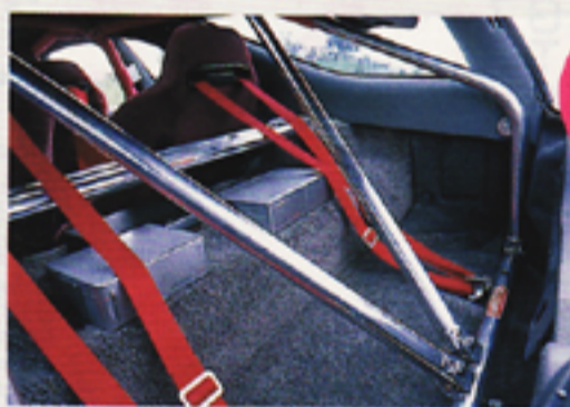
リヤのショルダーベルトはロールケージにマウントされているのだ。もちろん、強度はバッチリだぜ！
