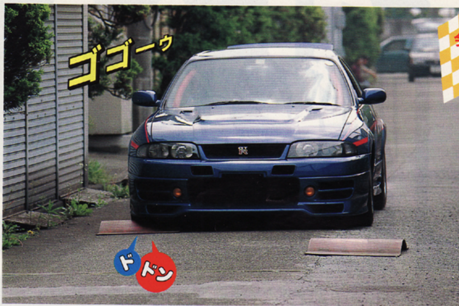
かまほこ状の鉄板に乗り上げて通過し、そのときのボディのゆがみ具合を測定するのが、ひずみ試験。鉄板の高さは80mmだ。
