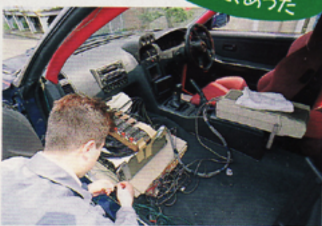
ゲージから実際のデータを取り出すための測定器がこれ。動ゆがみ測定器と電磁オシログラフと呼ばれるものだ。
