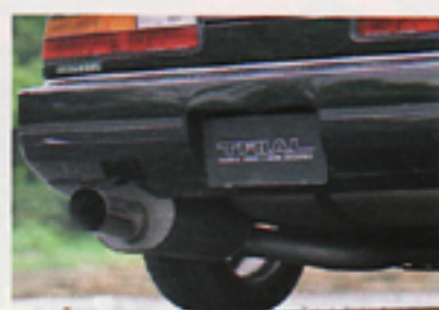
メインパイプ70φから115φで抜くオリジナルマフラー。排気効率をとことん達及したモデルだ。
