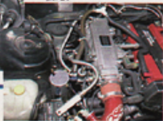
CAエンジンはちょっとブン回すとすぐにオイルが上がってくるので、オイルキャッチタンクは絶対に必要だ。
