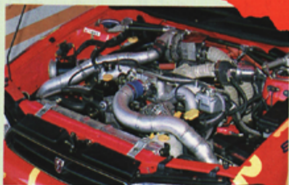
タービンはRX6B、カムはIN/EXともに284度。その他、補器類は全てアベックス製品に交換されている。
