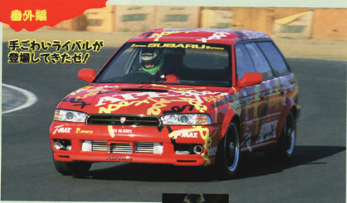
タービンはRX6B、カムはIN/EXともに284度。その他、補器類は全てアベックス製品に交換されている。
