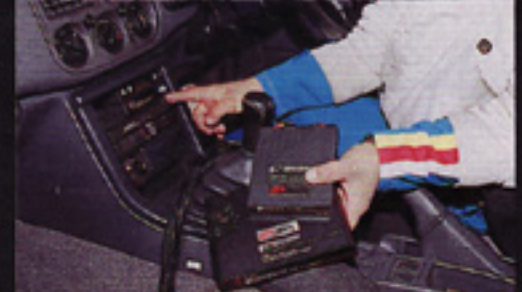
エアクリナーを高効率なモノにしたことにもなって、アベックス-AFC（エアフロコンバーター）によりエアフロ信号の補正を行い、燃調はFマネージ・Q/NとAIDで取る。そしてブーストをAVCRにより0.9kg/cm 2 まで高めている。
