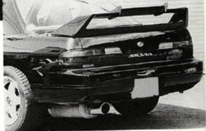
アクロスのリヤウイングはウイング部分の角度調節で、ダウンフォースが変えられる。サンデーレーサーには嬉しいシステムだ。
