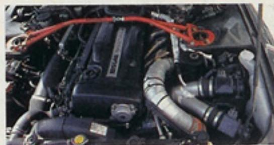
J&KステンレスEXマニホールド TO4S(A/R0.84) HKSレーシングウエストゲート 過給圧1.4kg/cm<sup>2</sup> ARCインタークーラー HKS75φマフラー F-CON(オリジナルロム)+GCCII 東名264/264°カムシャフト ニスモ強化クラッチ
