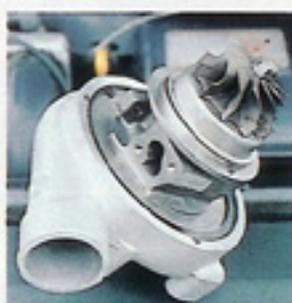
T04E並の風量を実現出来た理由は、コンプレッサーハウジングを大きくし、ブレードの枚数を増やしているからなのだ。
