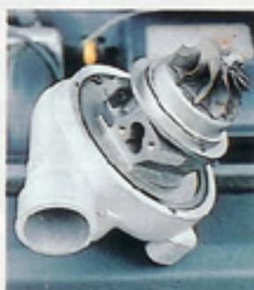
T04E並の風量が実現出来た理由は、コンプレッサーハウジングを大きくし、ブレードの枚数を増やしているからなのだ。
