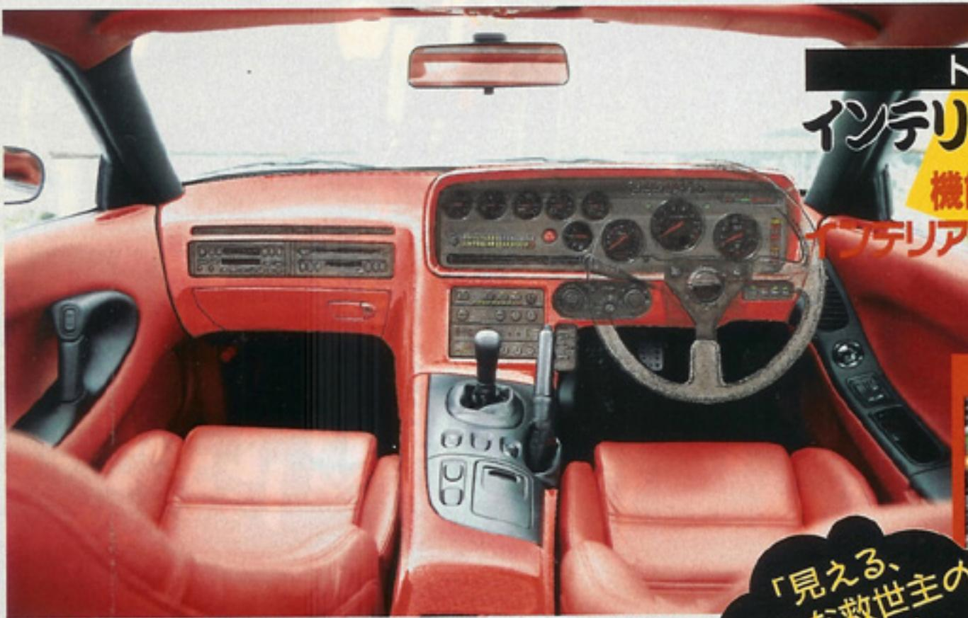
オリジナルはRX-7(FD3S)だが、ダッシュボードをオリジナルマイフするとかなり雰囲気が変わる。チューンドパワーに必須の追加メーター類は視認性重視の位置にセット。センターコンソールに制御系パーツをビルトインし、オリジナルのオーディオ類はナビシート側へ移動(しかし、シフトレバー前方に装着したリモコンスイッチでドライバーも操作可能だ)。こうした追加パーツのフィッティングを前提としての一体成形デザインなら、コンプリートカーも超えられるぜ。
