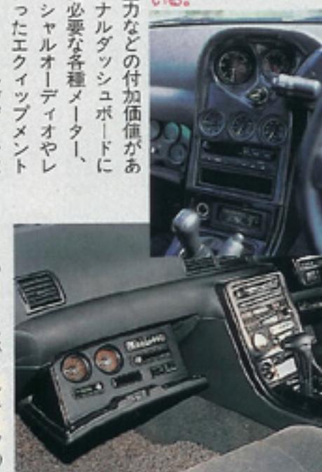
こちらはすでに市販されているHKSのエレクトリックコンソール。HKS製電子パーツをすきり装着できる専用ユニットだ。
