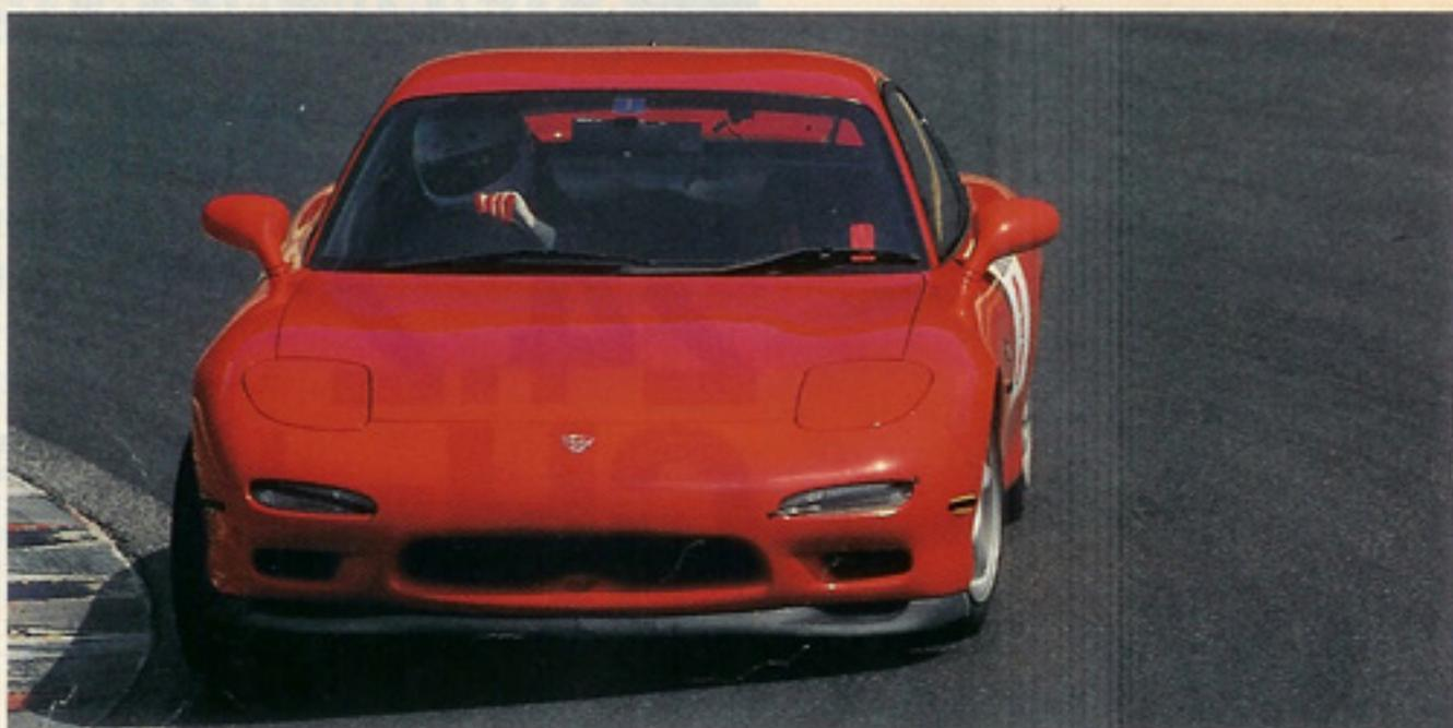
■DATA—EVC (最大1.0kg/cm<sup>2</sup>) F-CON GC CI FCD 試作インタークーラー パワーフローリーガルマフラー 試作ショック HKSメタルブレーキパッド
