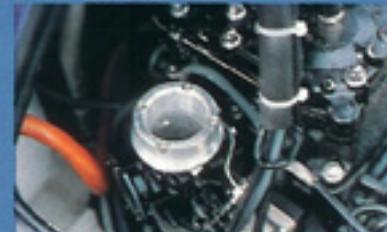
鏡のよう見えるのがステアリングノズル。中に見えるのがインペラ。ここで吸い込まれた水がジェット噴流となって吐き出されるのだ。ノズルはステアリングの動きに応じて動く。右側に見えるホースが冷却用の水路。
