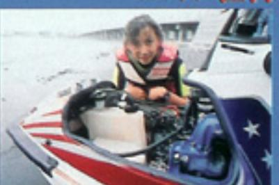
2サイクル2気筒エンジンを積むX-2。パワーはスタンダードで520S。白いボリタンクは混合ガソリンが入るタンク。青く塗装されているのがチャンバーだ。このチューンドX-2なら60psを発揮する。
